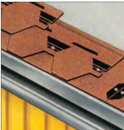
2. Læg første række shingles på fodpladerne. Begynd ved en af tagsiderne eller ved midterlinien. Styresporet i pladekanterne letter lægningen og giver en hurtig og rigtig indpassning af hver enkelt shingle. Bemærk! Det er kun på rygning- og fodpladerne, at bagsidefolien skal fjernes, ikke på selve shinglespladerne.
